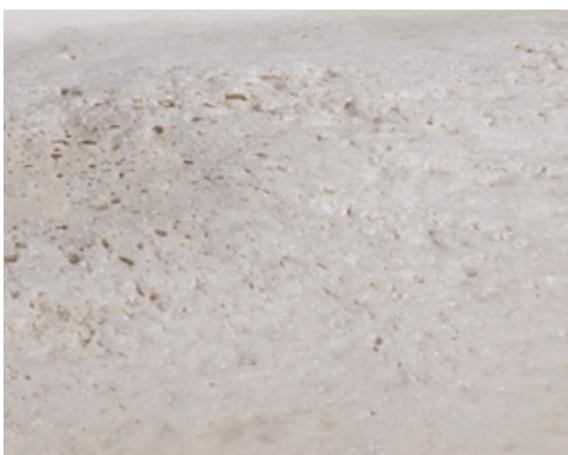
Atmosphäre. In den Poren des entstehenden Baustoffs, die einen Durchmesser von 0,5 bis 1,5 mm aufweisen, wird das entweichende Wasserstoffgas durch Luft ersetzt. Kurz nach Ende des Treibens ist auch die Abbindereaktion soweit fortgeschritten, dass der Rohblock standfest ist (Abb. 1.8). Nach drei bis sechs Stunden wird er aus der Gießform entnommen.
