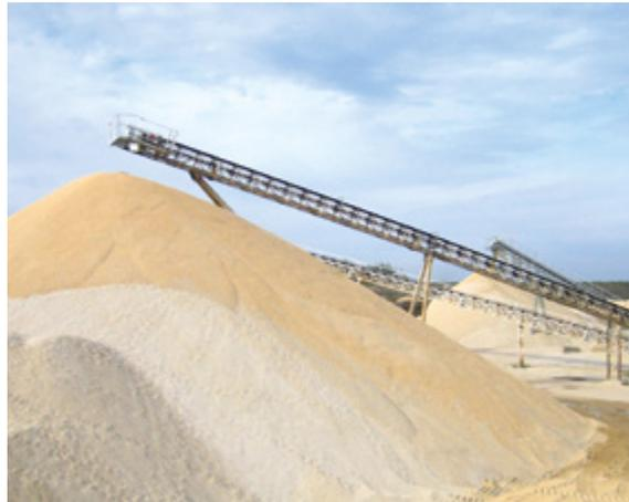
Abb. 1.2: Rohstoffgewinnung Sand für die Herstellung von Porenbeton
