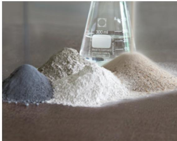
Abb. 1.3: Rohstoffe für die Herstellung von Porenbeton
